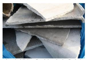
1993 besteht ein absolutes Verwendungsverbot, da das Einatmen der Asbestfasern Krebs verursachen kann. Die Gefahren durch asbesthaltige Materialien treten besonders bei Abbruch- und Instandhaltungsarbeiten und bei der Sanierung von Asbestzementverkleidungen auf. So manches sanierungsbedürftige Dach von land-
