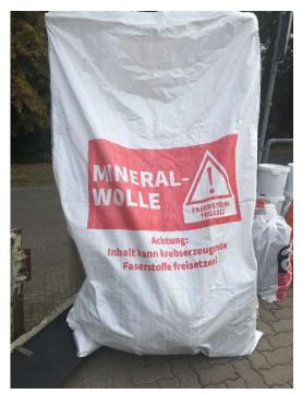
Diese speziellen Säcke zur Entsorgung von Mineralfaserabfällen können über den Fachhandel oder das Internet bezogen werden.
