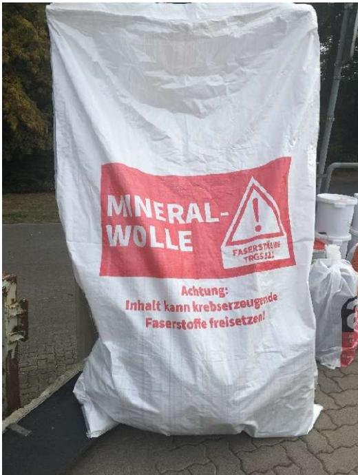
Diese speziellen Säcke zur Entsorgung von Mineralfaserabfällen können über den Fachhandel oder das Internet bezogen werden.
